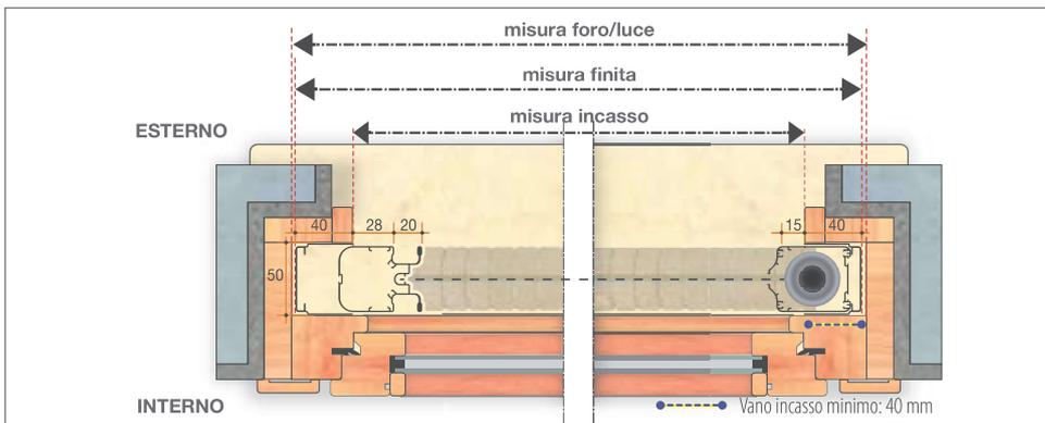
**1 2 V1 e V2 – Sezione orizzontale versione a due battenti**
