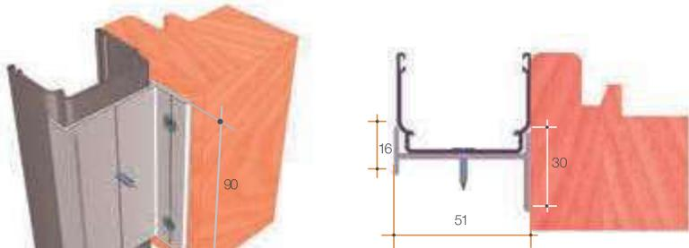
Il compensatore in alluminio risolve brillantemente la problematica di installazione in presenza di avvolgibili in monoblocco con ciellino ispezionabile dall'esterno, in quanto consente di ancorare la parte superiore della zanzariera direttamente sul serramento.
