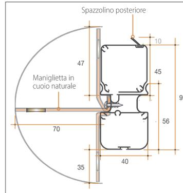
**Compensatore e guida montata.**
