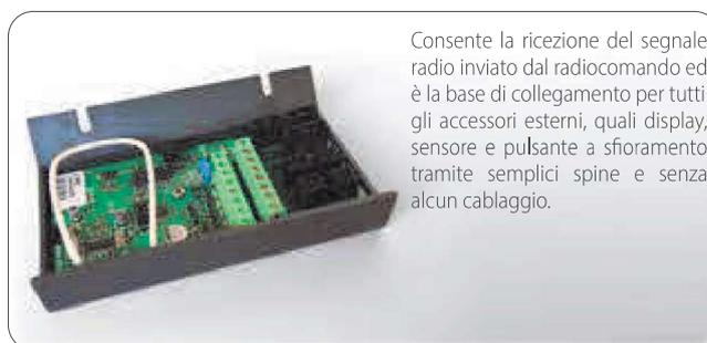
Consente la ricezione del segnale radio inviato dal radiocomando ed è la base di collegamento per tutti gli accessori esterni, quali display, sensore e pulsante a sfioramento tramite semplici spine e senza alcun cablaggio.
