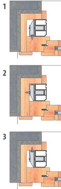
Insieme alla speciale guida reversibile, il compensatore alto permette addirittura tre tipologie di fissaggio:
