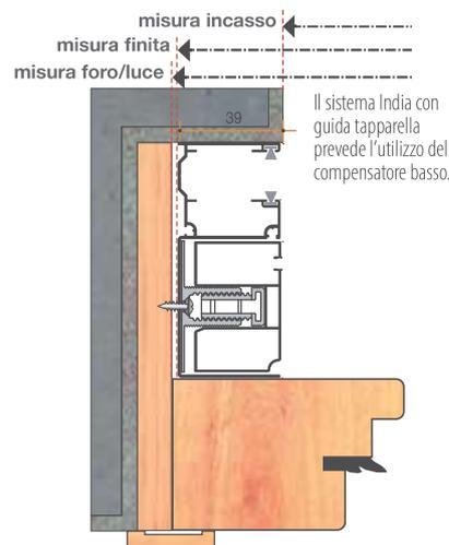
Esempio di installazione Guida Tapparella da 90 mm
