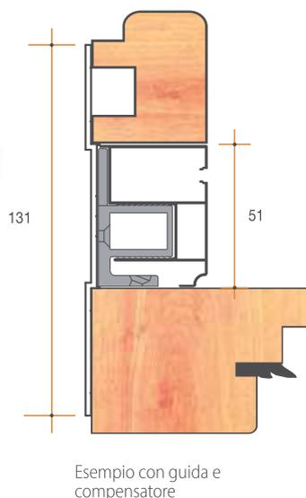
Esempio con guida e compensatore
